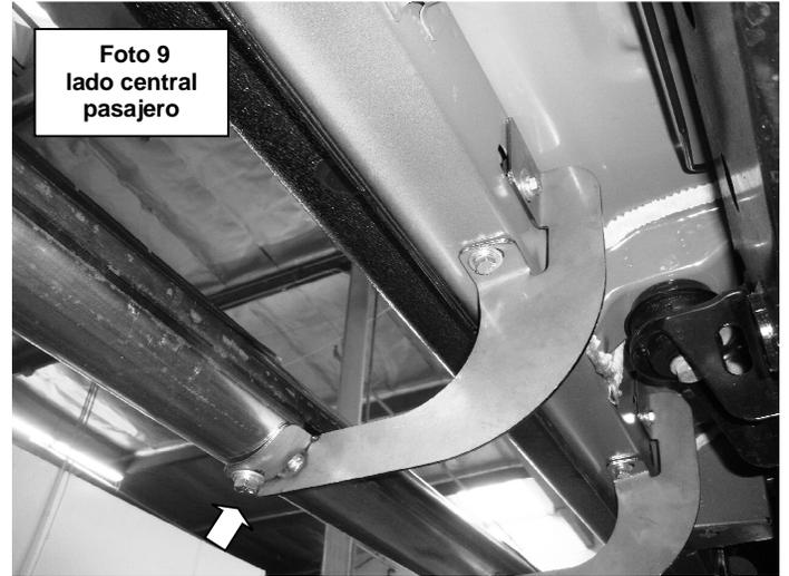
**Paso 6** Alinee el paso lateral con el vehículo y apriete todos los tornillos del soporte y del paso lateral, (foto 10). Repita los pasos anteriores para instalar los soportes del lado del conductor y paso lateral. Recuerde revisar periódicamente y vuelva a apretar los pernos.
