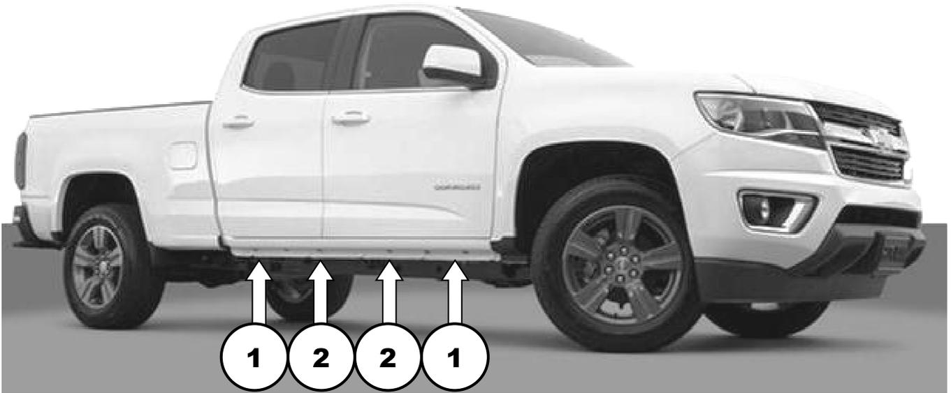
**Paso-1** Comienza la instalación en el lado del pasajero. Comenzando en la parte delantera del vehículo, localizar y eliminar los tapones de plástico en la parte posterior e inferior del panel bajo la puerta para exponer los agujeros utilizados para la colocación de las tuercas clip M8 , (**Foto 2**).
